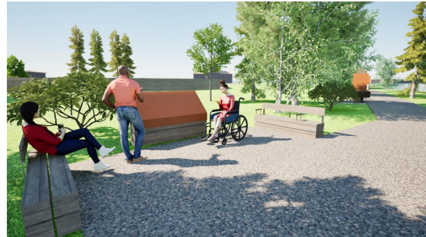
Kuva 36. Saavutettava opastetaulu. Jalusta puuta, opastetaulun pohja corten-terästä, johon voi kiinnittää teräslevylle painetut taulut.
