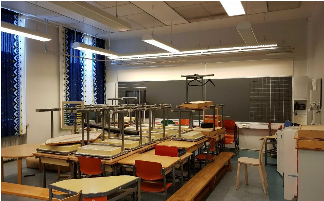
Luokkahuoneet ovat peruskorjauksessa toteutetussa asussaan. Tuolloin lattiapinnat on uusittu ja kattoihin on asennettu akustiikkalevyt ja riippuvat valaisimet. Alun perin luokkahuoneissa oli lakatut lankkulattiat. Luokkahuoneiden kaakon puoleiselle julkisivulle avautuvat ikkunat on uusittu, ilmeisesti peruskorjauksen yhteydessä.
